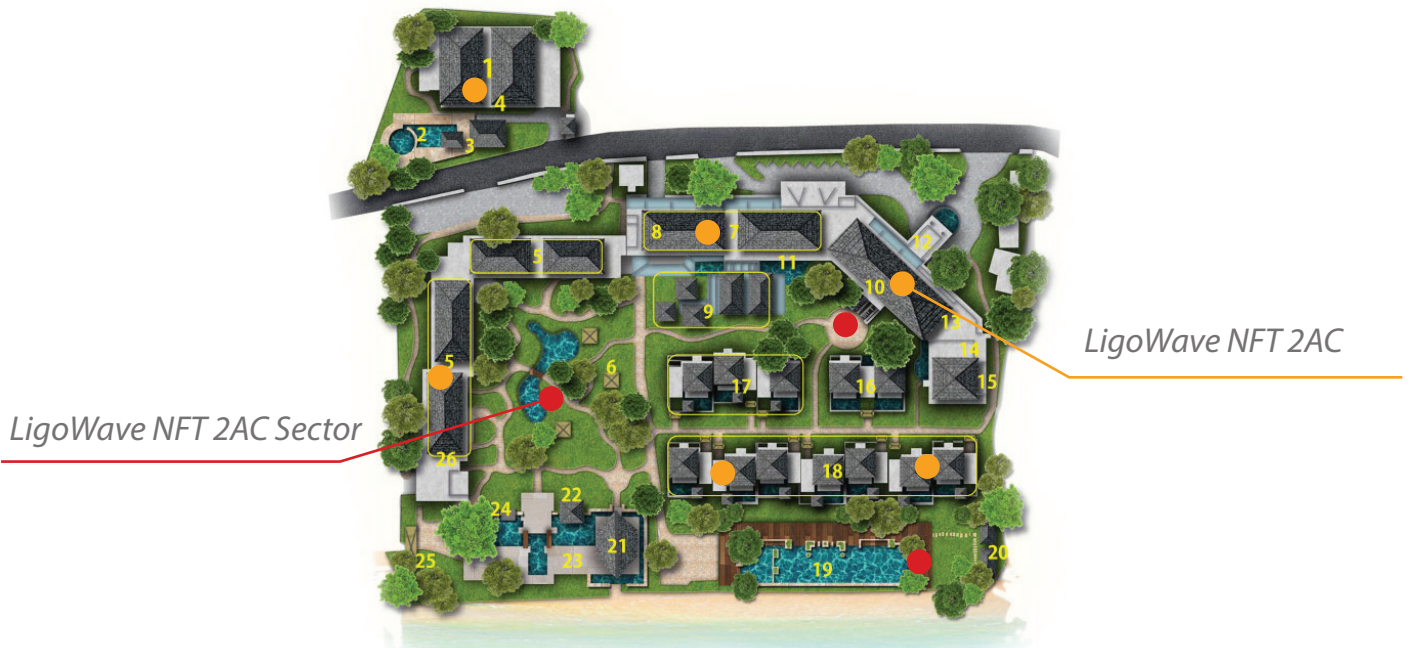
Mô hình lắp đặt và phủ sóng WiFi cho các khu vực trong resort
